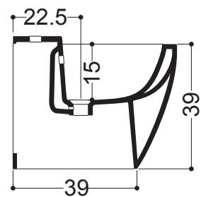
N.B.: Le misure indicate possono subire una variazione dello 0,8 % circa, dovuta ad usura stampi o a piccole variazioni delle caratteristiche tecniche relative alle materie prime che compongono l' impasto.
